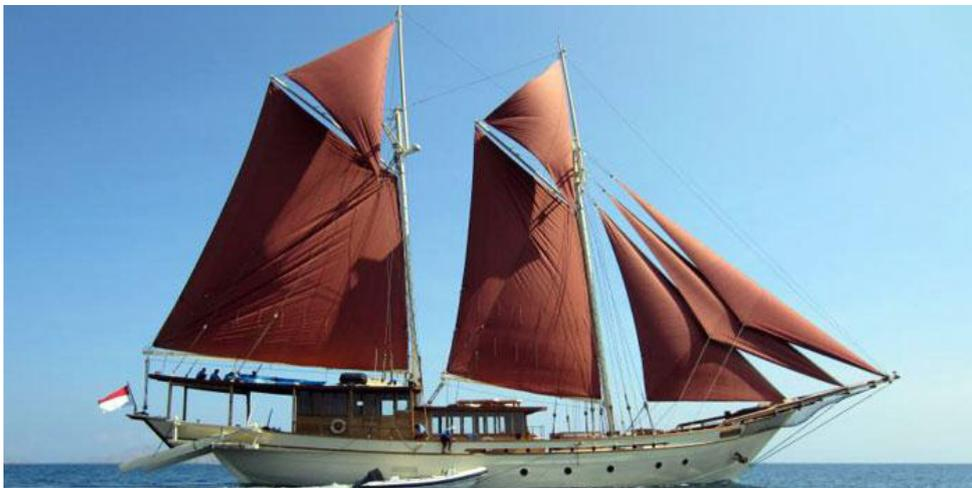
Gambar 2.3 Kapal Pinisi yang menggunakan angin sebagai penggerak kapal.
